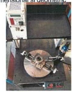
3. Echipament pentru controlul defectoscopic al inelelor de rulmenți
